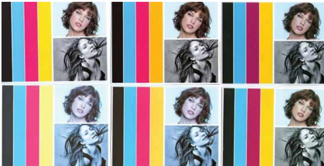
Вицвітання ELECTRA, E82, E83 на матовому фотопапері за 45 годин у камері SolarBox 1500
