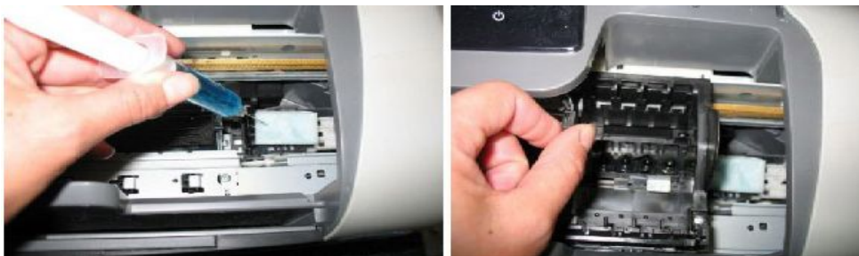
Рис. 12. Подготовка салфетки для очистки внешней поверхности головки и парковка на нее печатающей головки
