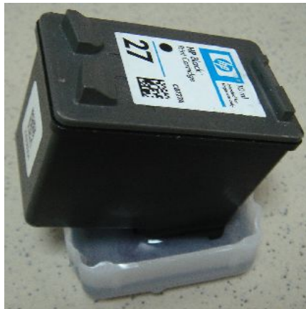
Рис. 8. Очистка внешней поверхности сопловой пластины картриджа методом окунания
