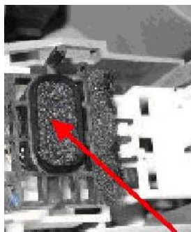
Рис. 10. Результат промывки капы – абсолютно чистый пеноматериал
