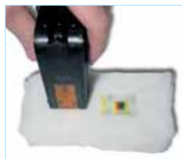
Фото 9. Отпечаток сопловой пластины, как метод проверки качества заправки
