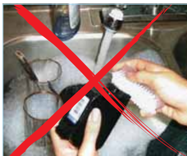
Фото 3. Неправильный способ очистки печатающей головки термоструйного картриджа
