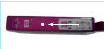
Фото 14. Заправка через вентиляционное отверстие чернильницы HP № 178, № 920
