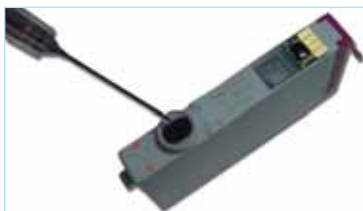
Фото 15. Заправка через выходное отверстие чернильницы HP № 178, № 920
