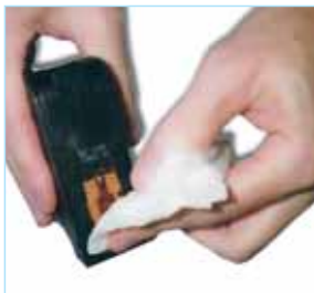
Фото 10. Очистка контактной пластины
