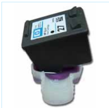
Фото 4. Правильная очистка печатающей головки (замачивание в очищающей жидкости CL10)
