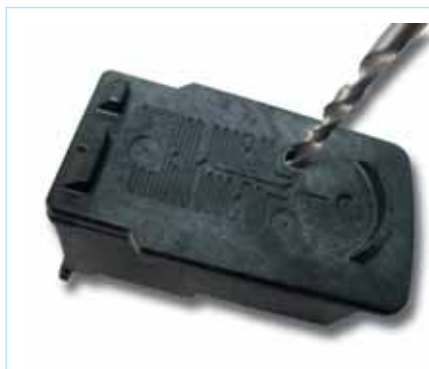
Фото 5. Рассверливание заправочного отверстия
