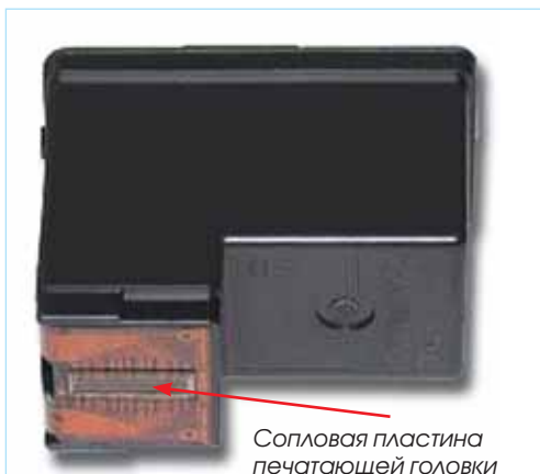
Фото 2. Печатающая головка находится в нижней части картриджа
